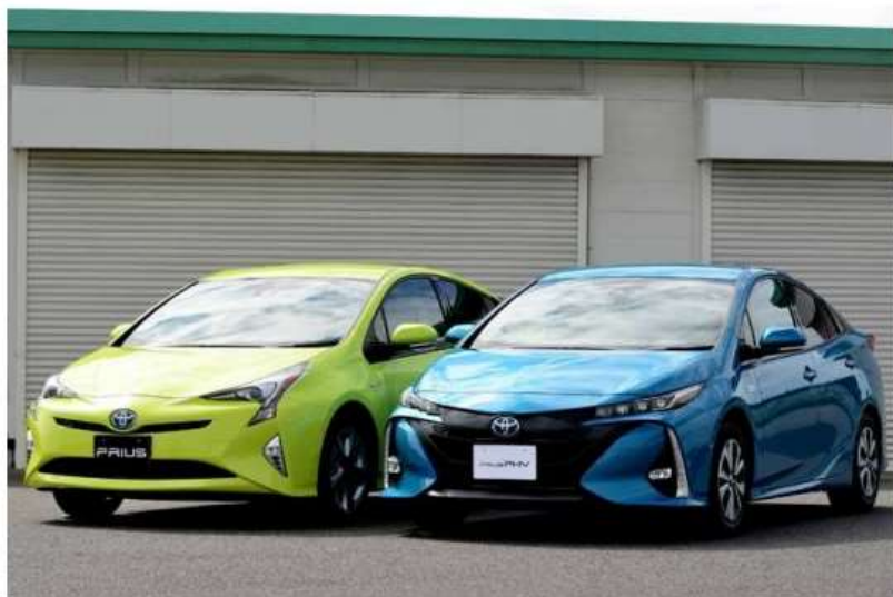
プラグインハイブリッド車 蓄電池を備え、ガソリンでも発電可能
